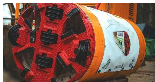
Obr.: Razicí štít Ludmila k opravě shybky Obříství
